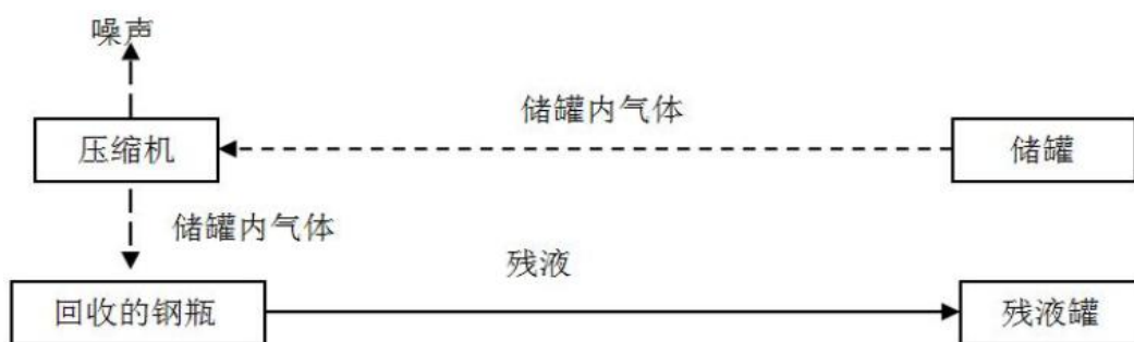
图2.1-4 钢瓶残液回收工艺流程及产污节点图
