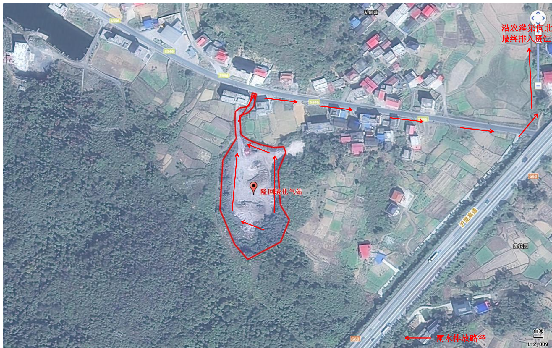
附图 7 项目雨水排放路径图
