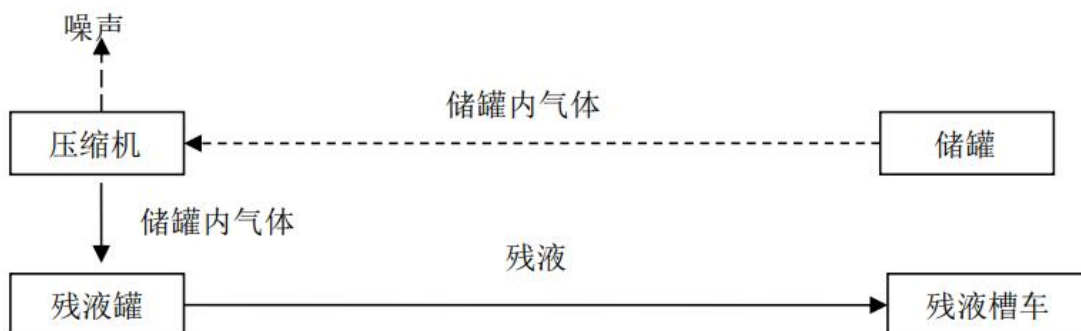
图2.1-5 残液罐残液回收工艺流程及产污节点图
