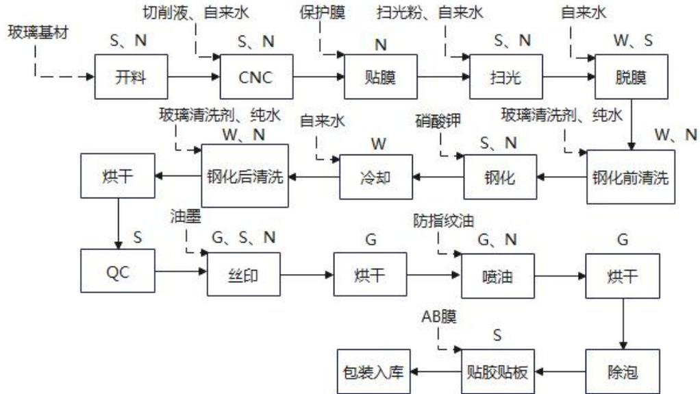
图 2-2 钢化玻璃膜生产工艺流程及产污节点图
