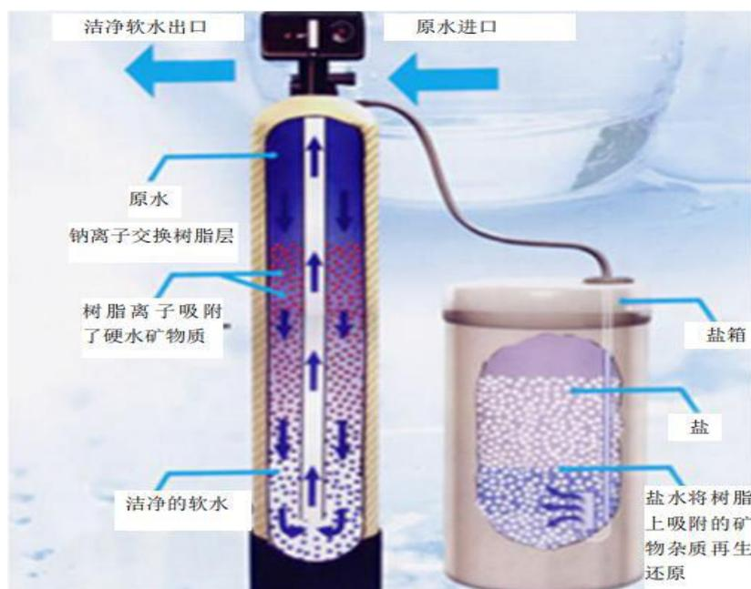
图 2-9 软水制备工艺图
