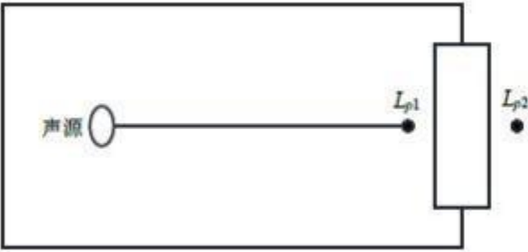
图3.2-1 室内声源等效为室外声源示意图
