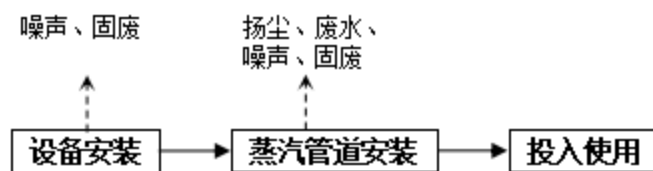
图 2-2 项目施工期建设工艺流程及产污环节示意图
