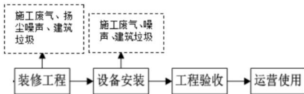
图 2-2 施工期工艺流程及产污环节分析图
