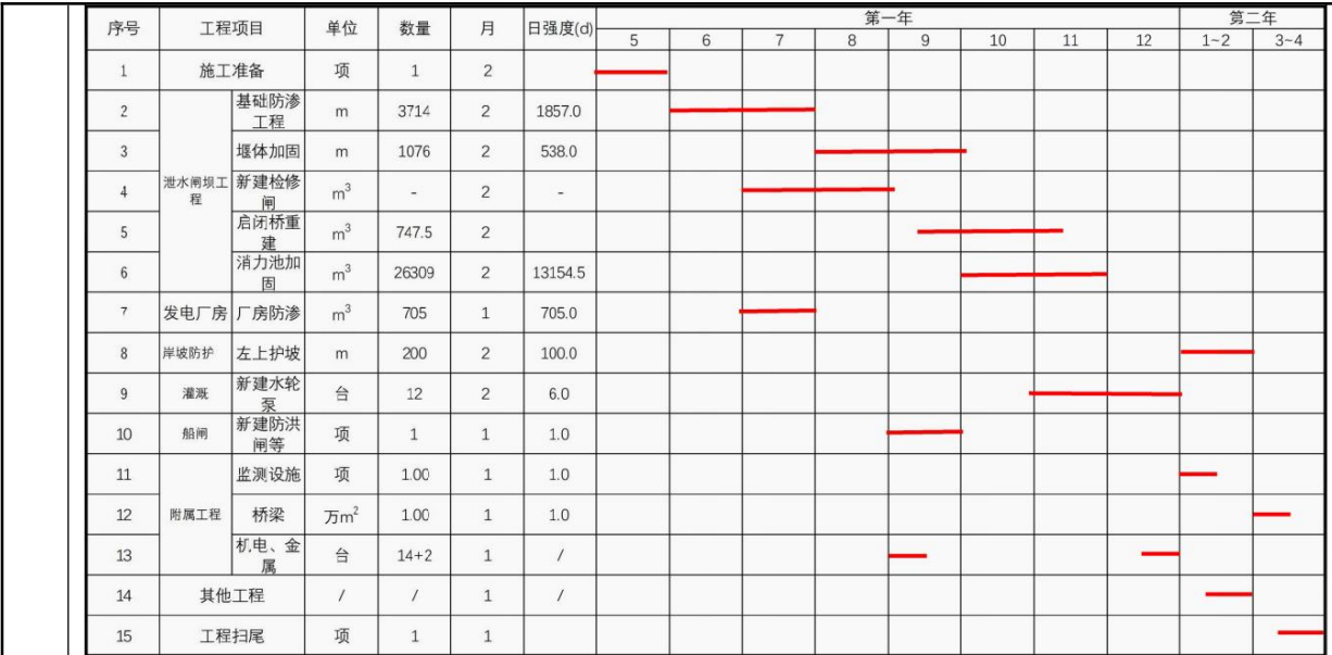
图 2-2 施工总进度横道图
