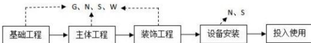
图 2-2 施工期工序流程及产污环节图
