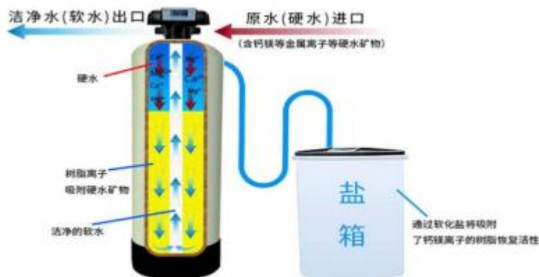
图4-2 软水制备原理图
