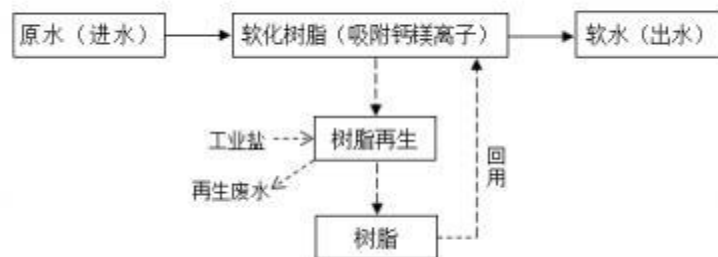
图4-1 软水制备工艺流程图
