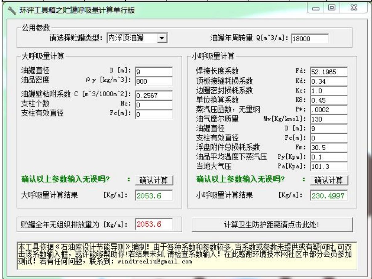
图 4-1 内浮顶罐大、小呼吸产生量核算结果
