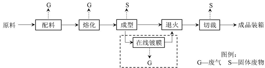
注：图中在线镀膜工序的虚线方框代表可选工序。
